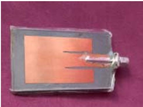
Figura 15. Antena em microstrip tipo "patch" retangular medida.
